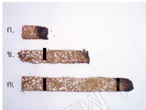
ภาพที่ 5 ภาพชิ้นงานจากการเผาไหม้ของแผ่นใยไม้อัดจากเส้นใยกับโฟมพอลิสไตรีน ก. ชิ้นทดสอบที่ไม่มีการผสมสารกันการลามไฟ ข. ชิ้นทดสอบที่หยุดการเผาไหม้ได้ด้วยตัวเอง ค. ชิ้นทดสอบที่ไม่เกิดการเผาไหม้
